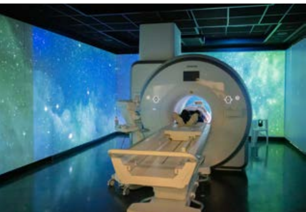
Kinder-MRT am Klinikum: Videoprojektionen, leise Technik und eine besonders weite Röhre helfen dabei, Kindern eine möglichst an- genehme Untersuchung zu ermöglichen.
